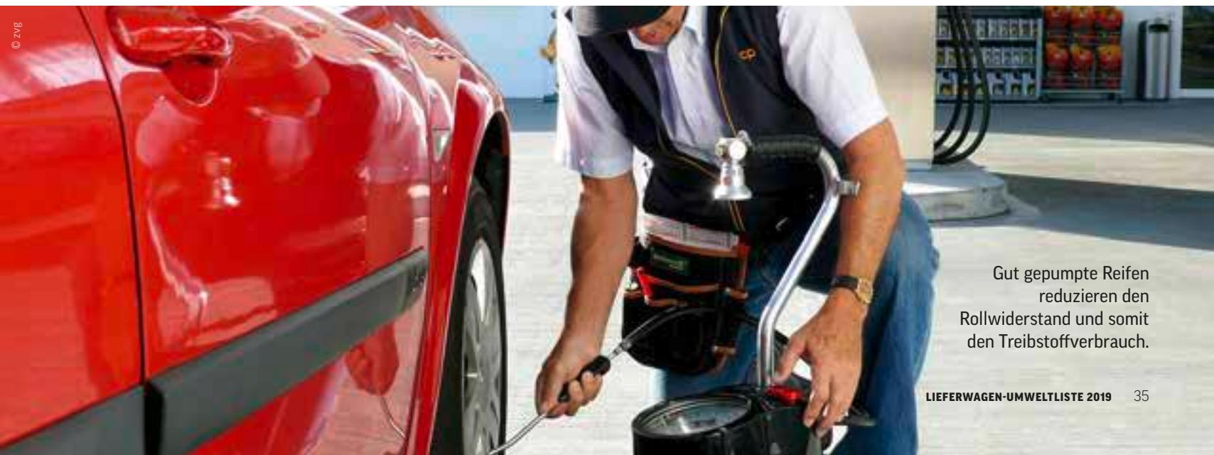
Gut gepumpte Reifen reduzieren den Rollwiderstand und somit den Treibstoffverbrauch.
